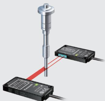
シャフトの径を測定します。独自のヘッド構造とアルゴリズムで、金属の2次反射にも影響されにくい安定した検出が行えます。
